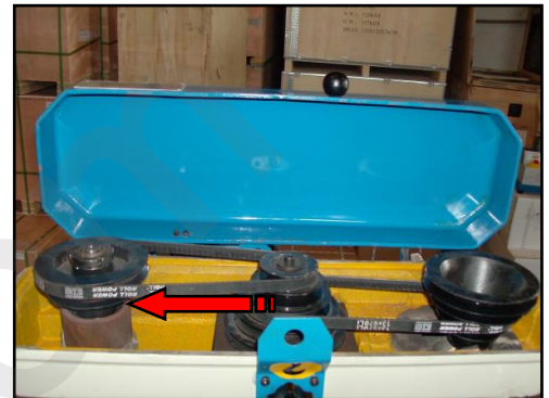
Figura 11 – Allentare la tensione.
