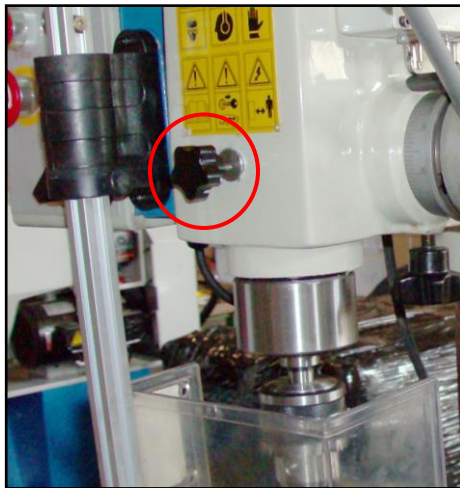
Figura 24 – Smontaggio del mandrino.
