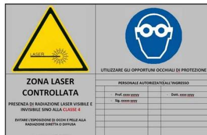
Fig. 7.2.2\_1 esempio di segnaletica nel caso di presenza di Laser in classe 4 con emissione di radiazione sia visibile che non visibile
