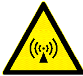
Figura 6: segnaletica di presenza di radiazioni elettromagnetiche.
